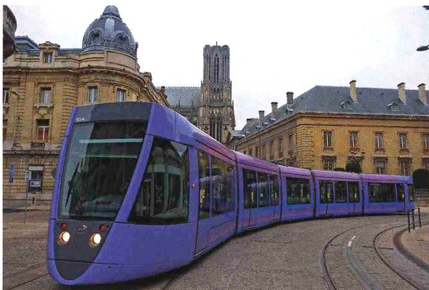
Discrète au pied de la cathédrale : l'alimentation par le sol remplace la ligne aérienne de contact pour la traversée du centre-ville.
